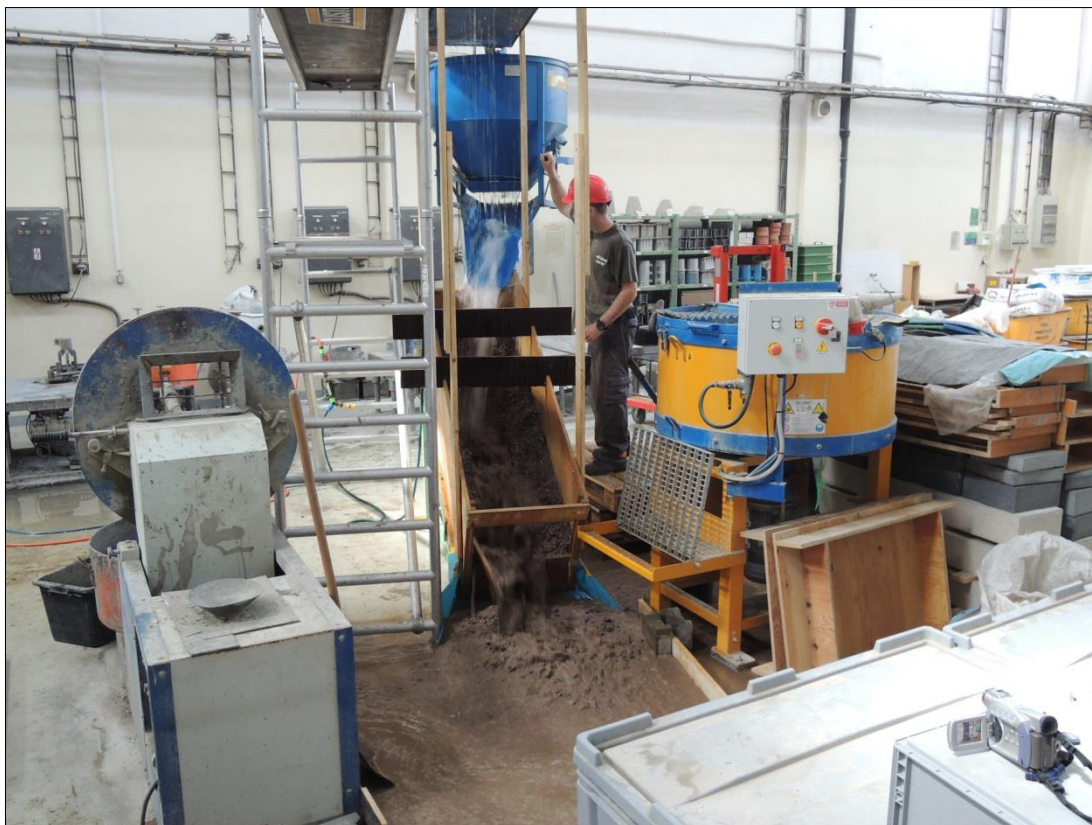
Obr. 62. Simulátor ZEKAPR s dešťovým simulátorem extrémní srážky v laboratořích ČVUT FSv.
