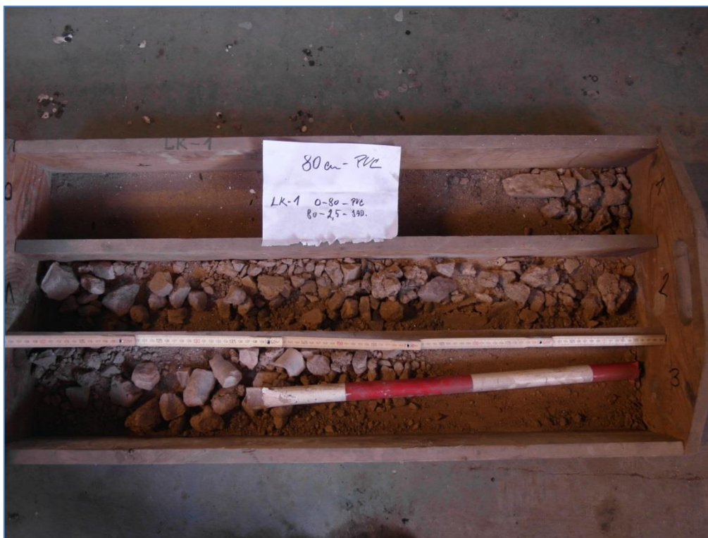
Obr. 30. Pohled na jádro vrtu ve vzorkovnici - sonda LK1
