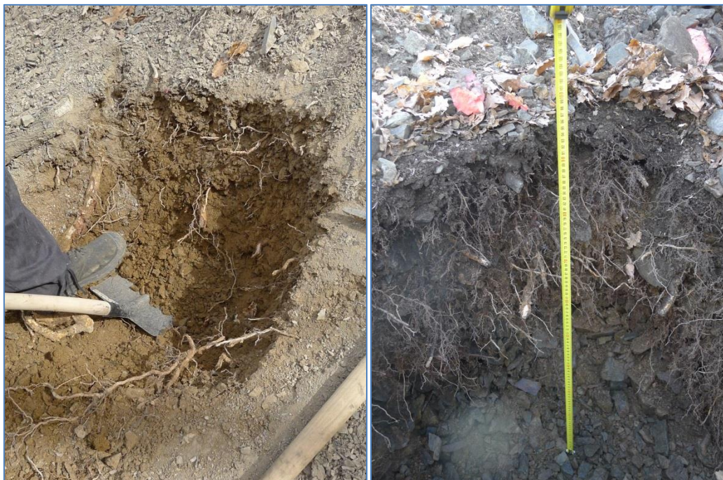
Obr. 44. Provádění kopané sondy ZK 1 a výsledná hloubka sondy ZK 2
