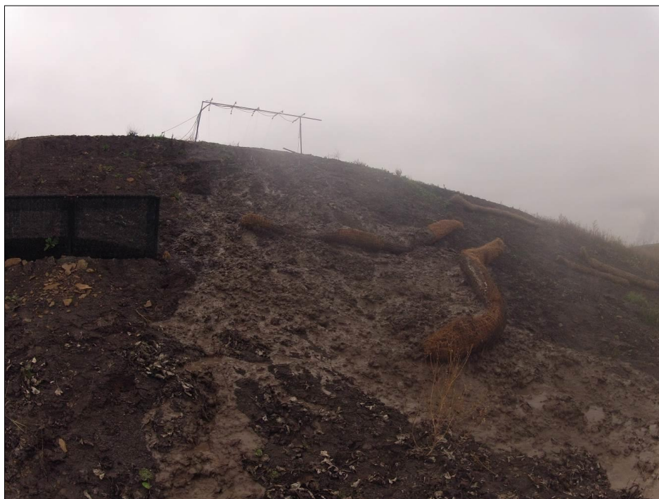
Obr. 60. Drobný sesuv na testovací lokalitě během dešťové simulace.
