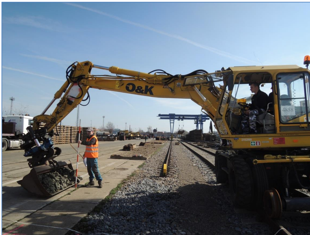
Obr. 67. Příklad měření dosahu stroje MHS.2 za modelovanou záchytnou bariérou
